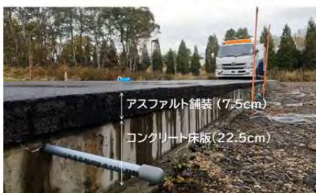
非破壊検査(レントゲンによる埋設物撮影)
