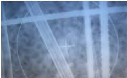
非破壊検査(レントゲンによる埋設物撮影)
